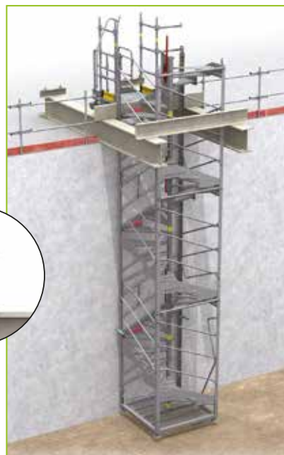
- Esquema de uma EscAlphi MDS suspensa para aceder a um local em profundidade.
