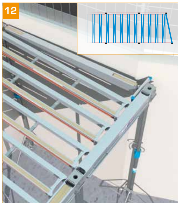
- As cabeças articuladas da vigota secundária angular permitem a adaptação a todas as configurações.
