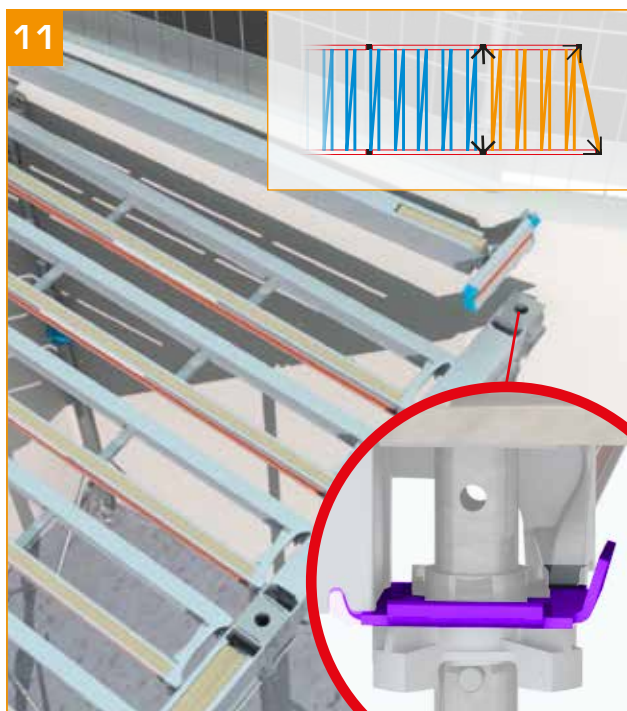
- Montar a vigota secundária extensível angular.
